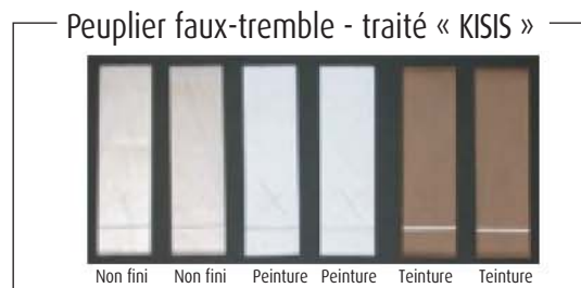
Peuplier faux-tremble après 1500 heures de vieillissement
