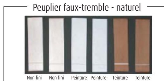
Peuplier faux-tremble après 1500 heures de vieillissement
